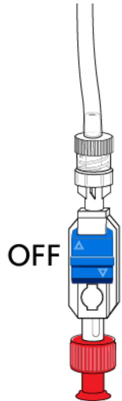
Figura 2. Interruptor de caudal y tapón desechable
