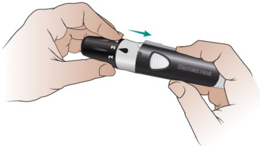
Figura 8. Vuelva a tapar el dispositivo de punción
