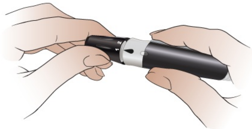
Figura 9. Establezca la profundidad de la punción
