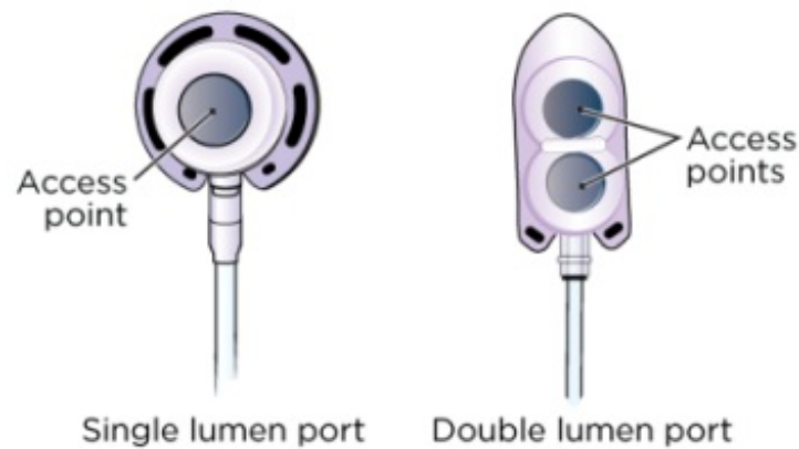
Imaj 3. Orifis ki gen yon sèl limyè (agoch) ak orifis ki gen doub limyè (adwat)
