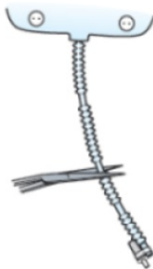
Рисунок 17. Как отрезать трубку
