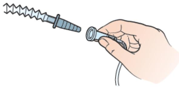
Рисунок 19. Как вставить соединитель в широкий конец трубы
