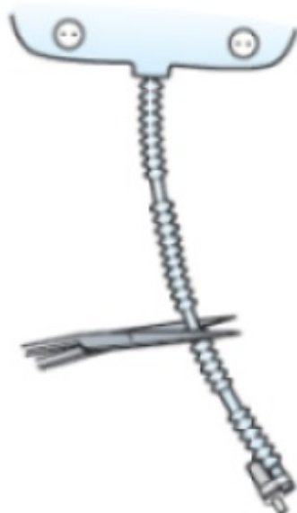
Рисунок 17. Как отрезать трубку
