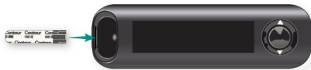
Рисунок 10. Вставьте тест-полоску в порт
