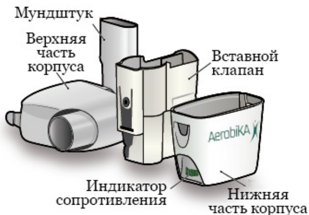
Рисунок 2. Устройство Аеробика в разобранном виде
