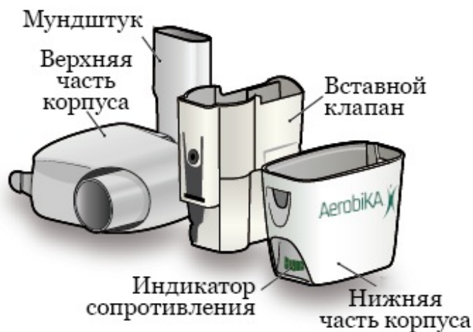
Рисунок 2. Устройство Aerobika в разобранном виде
