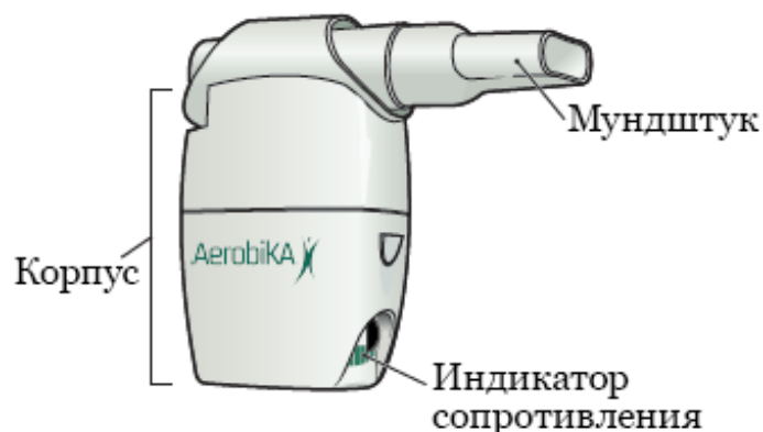
Рисунок 1. Детали устройства Aerobika
