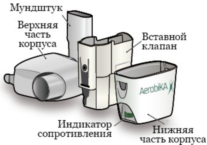
Рисунок 2. Устройство Аеробика в разобранном виде
