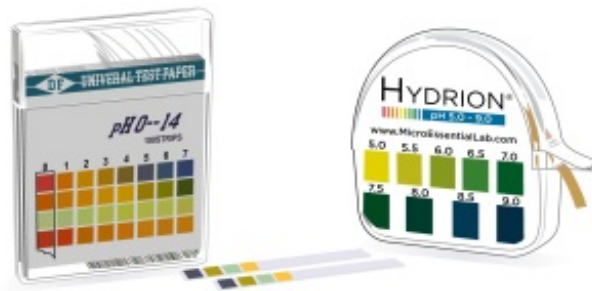
Рисунок 3. Пластиковые полоски для определения уровня pH (слева) и бумажные полоски для определения уровня pH (справа)
