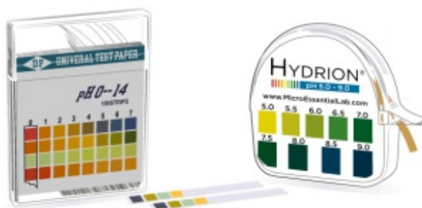
Рисунок 2. Пластиковые полоски для определения уровня pH (слева) и бумажные полоски для определения уровня pH (справа)
