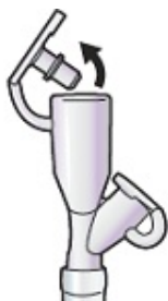
Рисунок 3. Откройте заглушку на конце соединителя старого образца (слева) или соединителя ENFit (справа)
