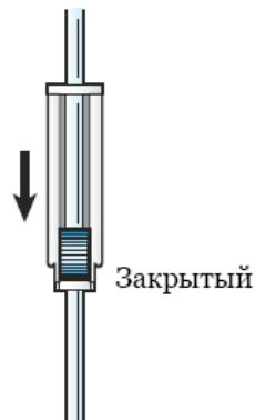
Рисунок 3. Закройте роликовый зажим
