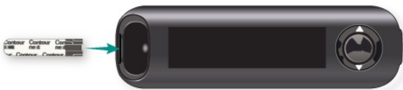
Рисунок 10. Вставьте тест-полоску в порт
