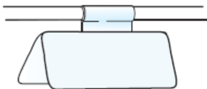
图 9. 将 UC strip 的中心部分敷贴在导管上
